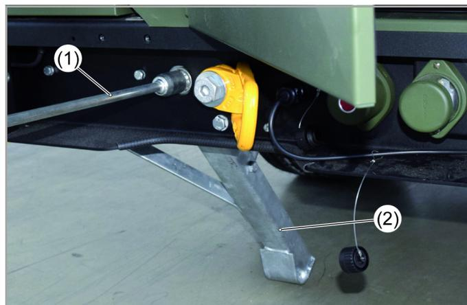
Bild 33: Klappstütze ausfahren
