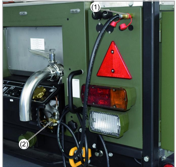
Bild 44: Kraftstoffversorgung Brenner
