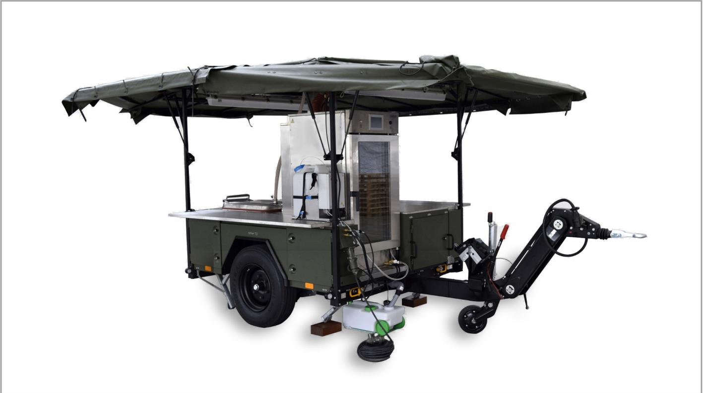
Bild 3: Anhänger Modulfeldküche, Ansicht von vorne rechts (hier: Bestückung mit KCS 15, Stauraummodul und zwei Kochmodulen)
