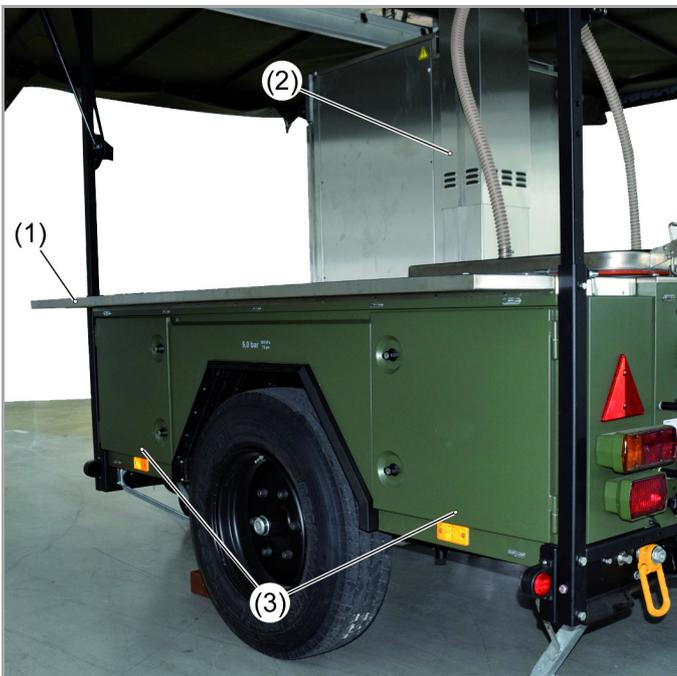
Bild 11: Seitenstaukasten
